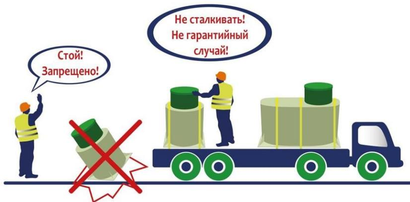
В качестве защитных материалов используют различные мягкие материалы: резиновые жгуты и кольца, ткань, пленку из поливинилхлорида, полиэтилена или полипропилена и т.п. Сбрасывание Изделий с транспортных средств не допускается.
