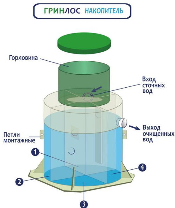
Рисунок 1. Устройство септика ГРИНЛОС Накопитель
