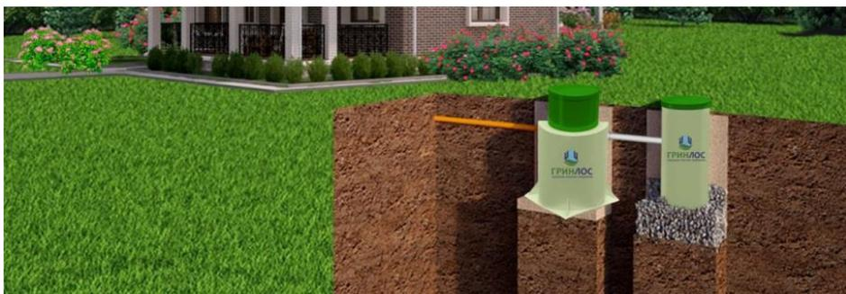
Подходит для хорошо поглощающих грунтов (песок, супесь) и низком уровне грунтовых вод. Колодец поглощения может быть выполнен из бетонных колец или при помощи пластикового колодца с перфорированным основанием и стенками. При монтаже колодца поглощения на выпуск трубы рекомендуется смонтировать обратный клапан для защиты Изделия от обратного затопления в периоды активного снеготаяния или в
