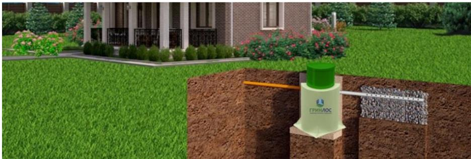
Этот вариант позволит сэкономить место на участке, однако дренажный элемент в большей степени подвержен затоплению в условиях подъема грунтовых вод.
