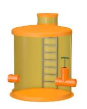
Гашения Колодец ГРИНЛОС, иначе называется" гаситель", используется для снижения давления перед очистными сооружениями при подаче сточной воды под давлением из аккумулирующего резервуара. Диаметр подводящего патрубка таких колодцев определяется размерами подводящей линии, а отводящий патрубок – диаметром самотечной линии.
