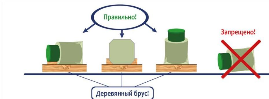
Место хранения Изделий должно быть ограждено для предотвращения механических повреждений строительной техникой. Запрещается волочение Изделия по грунту до места складирования и монтажа.
