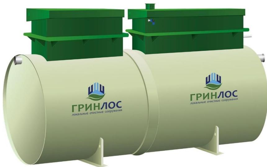
Переливы в Изделии расположены таким образом, чтобы сточные воды протекали с наименьшей скоростью, благодаря чему в каждой камере происходит оседание грубодисперсных взвешенных частиц на дно. Из приемной камеры-накопителя сток попадает в камеру преаэрации где инициируются процессы аэробной очистки стока, а также происходит нитрификация стока.
